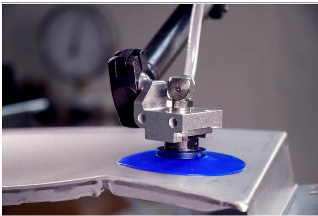
Soporte para ventosa HT-SG en combinación con ventosas tipo campana SAX durante la manipulación de una pieza de chapa
